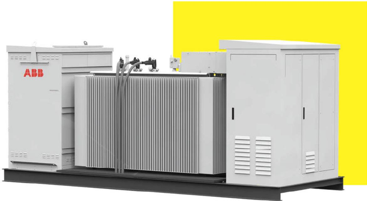
El MVCS incluye el transformador de media tensión bañado en aceite, las celdas de línea y protección de media tensión en hexafluoruro de azufre y las protecciones y conexiones de baja tensión para conectar inversores PVS-175-TL respectivamente, así como los servicios auxiliares. En concreto se conectarán 30 inversores por centro de transformación para una potencia de 5.550 kVA por centro hasta un total de nueve centros. Esto da una potencia total de inversores y transformador de 49.950 kVA.
